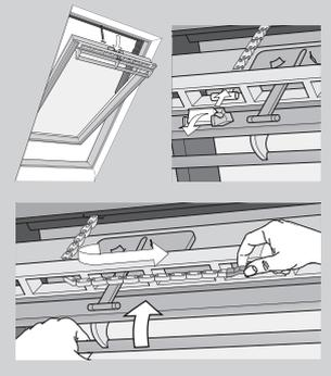
V prípade výpadku elektrického prúdu sa dá vaše kyvné strešné okno zatvoriť manuálne odpojením reťaze ventilačnej klapky okna. Na webovej lokalite [www.velux.com](http://www.velux.com) nájdete podrobné pokyny pre ovládací panel na manuálne zatvorenie okna.
