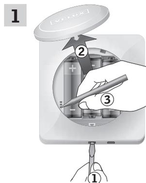
A gombot csavarhúzóval megnyomva távolítsa el az elemfedelelet, amit az ábrán látható **1**, **2**.
