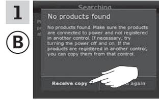
Bir kopya **alacak** **(B)** dokunmatik kumanda paneliyle başlayın. **Başlangıç kurulumu** bölümüne gidin ve 1-3 adımlarını gerçekleştirin. "Kopyayı al" öğesine dokunun. **Not:** Adım 5'e kadar ⇒ simgesine dokunmayın.
