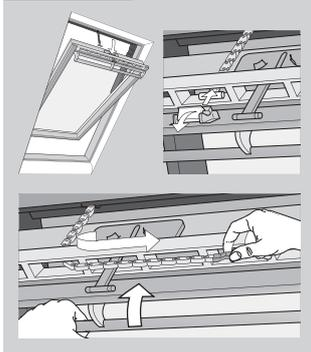
Em caso de falha de energia, a janela basculante pode ser fechada manualmente desengatando a corrente na aba de ventilação da janela.
