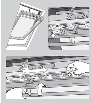
Áramszünet esetén a szellőzőnyílás láncának kiakasztásával zárhatja be kézzel a billenő tetőtéri ablakot. Az ablakok kézi bezárásával kapcsolatban az érintőképernyős vezérlő teljes útmutatójában található további tudnivalók, a [www.velux.com](http://www.velux.com) címen.
