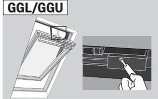
Dokunmatik kumanda panelinizi kaydetmeniz, pencereniz üzerindeki bir düğmeye basılarak kapatılabilir. Pencere tipine bağlı olarak, pencerenizi dokunmatik kumanda paneli olmadan nasıl kapatabileceğinizi [www.velux.com](http://www.velux.com) adresindeki tam talimatlarda görebilirsiniz.
