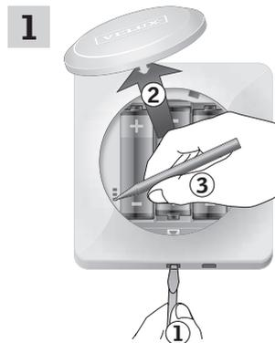
Снимите крышку батарейного отсека, нажав кнопку отверткой, как показано на рисунке **1**, **2**.
