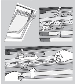
В случае сбоя питания или с помощью центральной осью открывания можно закрыть вручную, для чего необходимо отсоединить цепь вентиляционного клапана окна.
