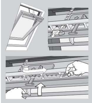
У разі вимкнення живлення вікна з відчиненням по центральній осі можна закрити вручну, від'єднавши ланцюг від вентиляційного клапану вікна. Дізнатися більше про те, як зачиняти вікно вручну, можна в докладних інструкціях про використання панелі керування на сайті [www.velux.com](http://www.velux.com).
