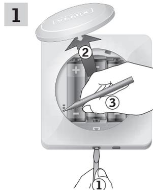
Remova a tampa das pilhas pressionando o botão com uma chave de fendas, conforme ilustrado **1**, **2**.
