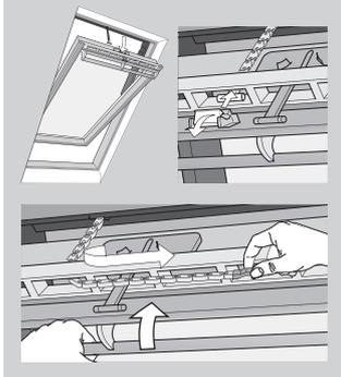
Sähkökatkon tapahtuessa keskisaranoidun ikkunan voi sulkea käsin irrottamalla ikkunan tuuletuskahvan ketjun.
