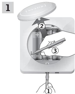
Odstráňte kryt batérie stlačením tlačidla pomocou skrutkovača, ako je znázornené na obrázku **1**, **2**.
